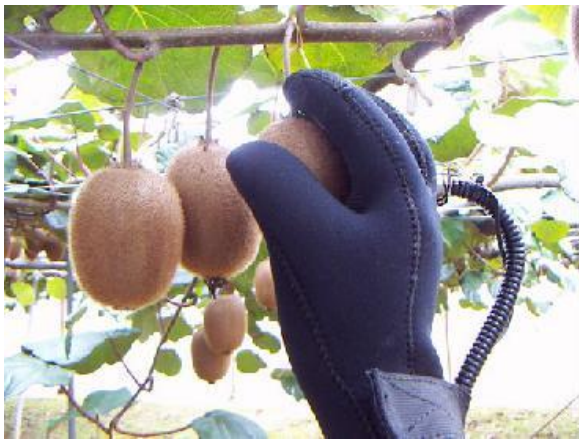
Figure 3. グローブ装置による樹上果実計測の様子
