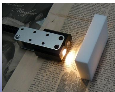
プローブ内蔵の同期制御 光源による反射計測配置
