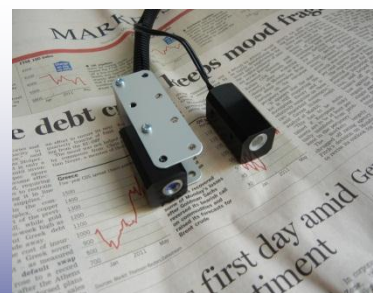
光源部と計測部が分離 可能なプローブ・ヘッド
